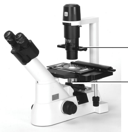
対物レンズと同じ MC コードのスリット絞りを光路に入れる
